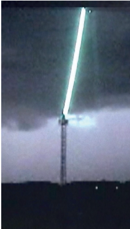
Bild 5. Blitzstromverteilung im Sendemast bei getriggertem Blitzereignis
